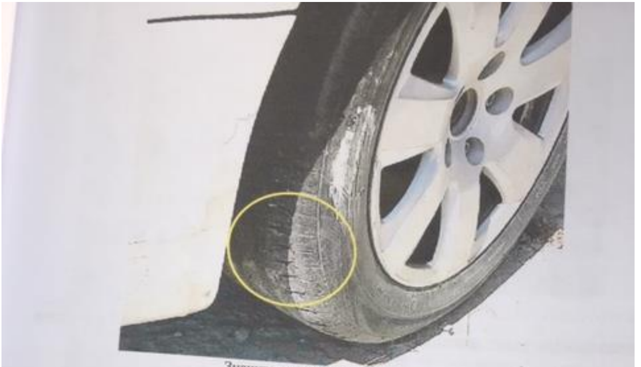
Значительный износ шин протектора
